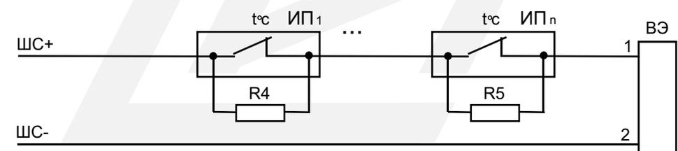
Схема включения ИО в ШС прибора
