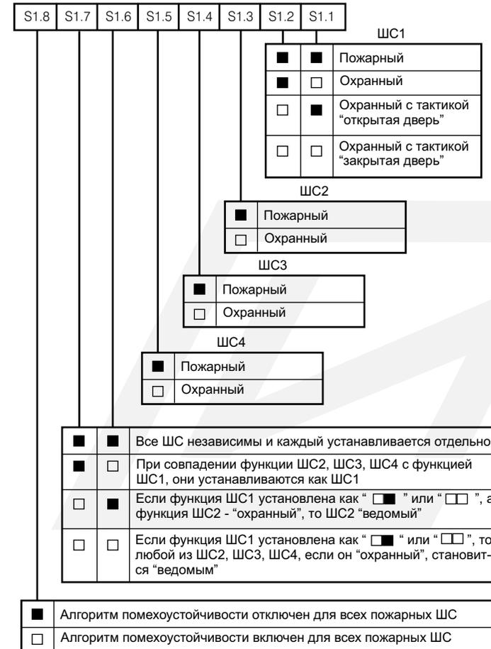
3.3.2 При запрограммированном ШС как “охранный” размыкание цепи “ВКЛ” для данного ШС переводит прибор из режима “Ожидание” в режим “Охрана”. В случае приема из ШС извещения “Проникновение” прибор переходит в одноименный режим и одновременно замыкает цепь “ОЗ”.
